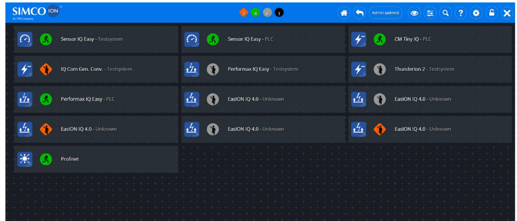
Ganz neue HMI-Schnittstelle. Verbinden Sie entweder über Feldbus mit Ihrer Maschinschnittstelle oder steuern Sie das IQ System Browserbasiert über einen Laptop, Tablet oder ein Smartphone. Sie haben die Wahl, der Smart SLC macht es möglich.
