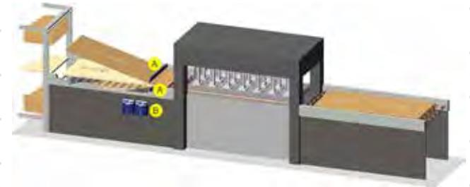
**A** Aufladestäbe **B** Hochspannungsnetzteil
