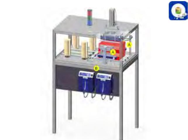
**A** Aufladestäbe **B** Hochspannungsnetzteil
