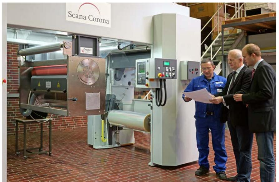
Die Wärme der Coronaentladung überträgt sich zum Teil auch auf die behandelte Materialbahn. Das führt zu Mikrofalten und partieller Rückseitenbehandlung, die in vielen Fällen störend ist. Die Kühlluft der Elektroden kühlt die Bahn gleich mit, sodass deren Temperaturerhöhung beherrschbar ist und im zulässigen Rahmen bleibt. Das Material wird geschont.
