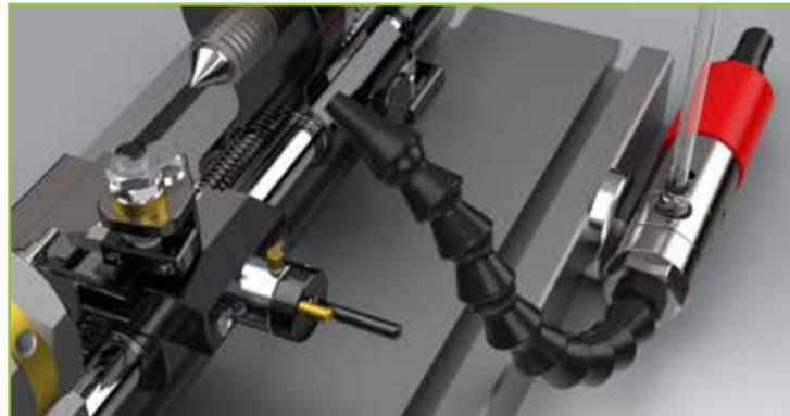
Kühlen von Teilen auf Präzision, unter Verwendung der **Kaltluftpistole** zur Kühlung der bearbeiteten Teile mit einstellbaren Schläuchen.
