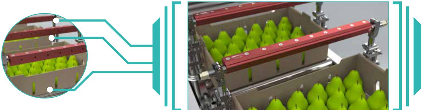
Die **Luftvorhänge RA-2 450** erleichtern z. B. das Trocknen und Reinigen von kleinen Partikeln auf frisch gepflücktem Obst.
