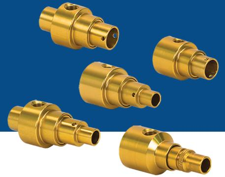
Vortec Luftstrahler sind rundhalsige Luftstromverstärker: ein Ende sorgt für einen starken Luftstrom, während das andere einen Sog erzeugt, indem freie Luft mitgerissen wird. Da die freie Luft mitgerissen wird, verstärken die Düsen das Luftvolumen um das bis zu 4-fache der zugeführten Druckluft, was zu einem geringeren Druckluftverbrauch bei gleicher oder größerer Schubleistung führt.
