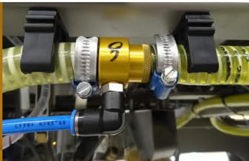
Die Größe des Drucklufteingangs ist bei allen Modellen 1/8" - 27 NPT-Innengewinde. Alle Luftstrahler sind aus eloxiertem Aluminium gefertigt und können mit Unterlegscheiben versehen werden (außer Modell 909A), um den Ausgangsschub, die Ansaugung und den Luftverbrauch anzupassen. Die Angaben zu Schubkraft und Luftverbrauch gelten bei 6,9 bar (100 psig). Die Verstärkung beträgt 4:1..
