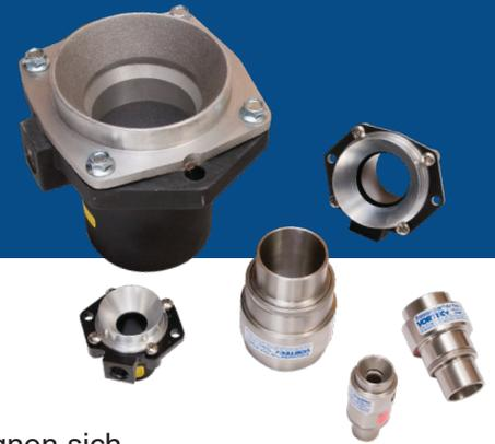
Luftstromverstärker liefern einen großen Luftstrom zum Befördern, Trocknen, Kühlen oder Lüften. Die Hochleistungsgebläse haben keine Klingen oder beweglichen Teile und sind daher von Natur aus sicher. Sie verstärken die Druckluftmenge in kanalgeführten Anwendungen um das 5-20-fache. Sie eignen sich besonders zum Entfernen von Metallspänen und -abfällen, zur Entlüftung von Rauch oder Dämpfen und zur Beförderung von kleinen Teilen, Pellets, Pulver und Staub.
