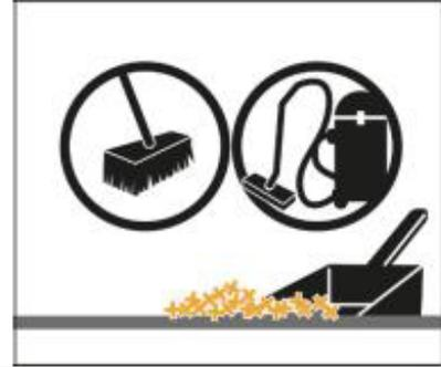
Das kontaminierte Oilex kann umgehend zusammengekehrt oder mit einem Industriesauger aufgesaugt werden – die Griffbarkeit des Untergrundes ist sofort wiederhergestellt.
