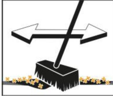
OILEX leicht einbürsten – am besten mit einem Besen – die Substanz wird sofort gebunden.
